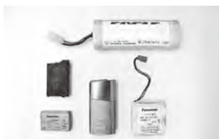
②ニッケルカドミウム、リチウムイオン電池等の充電式電池
